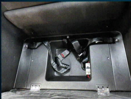
後部シートを上げると小物入れと メインバッテリースイッチ
