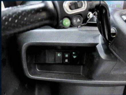
ファン・デフスイッチ ワイパースイッチ バックフォグランプスイッチ
