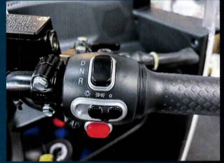
ドライブ切り替え (ドライブ・ニュートラル・リバース) ポジションライト・ライト点灯スイッチ
